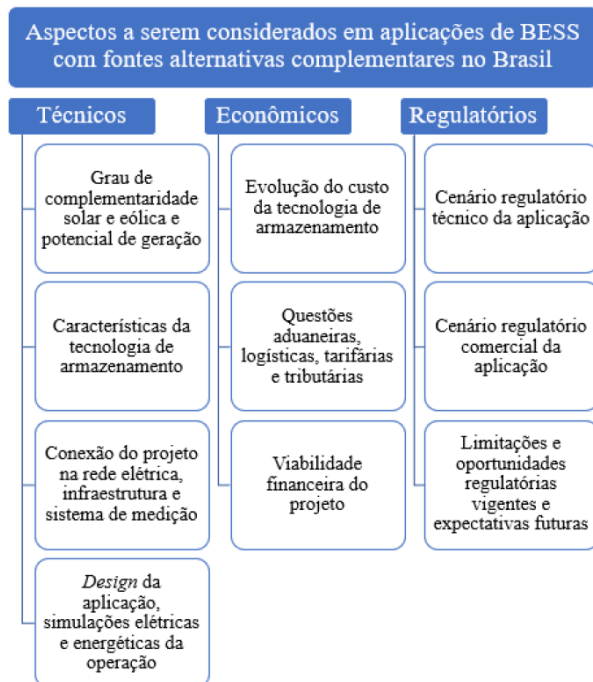
Figura 3. Aspectos a serem considerados em aplicações de BESS com fontes alternativas complementares no Brasil
